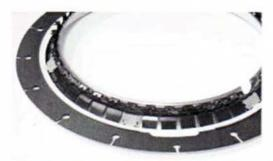
Nachdem der Weißwandring nun fest mit dem Edelstahlring verbunden ist, den schwarzen Unterring in den Weißwandring einlegen und die gesamte Einheit in die Felge anmontieren.
