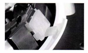
3. Die restlichen 5 Kunststoffclips werden regelmäßig am Edelstahlring verteilt und eingeclipst.
