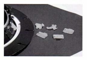
Der erste Kunststoffclip wird direkt neben der Aussparung am Weißwandring mit einem Abstand von ca. 1cm positioniert, dazu die Nase in die Einkerbung vom Weißwandring legen, dann an ein Blechfeld des Edelstahlringes einclipsen.
